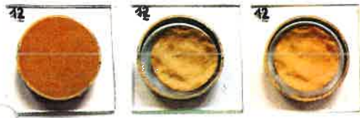
Einbau am 20.06.2011 Nach 192 Std. (8 Tage) Nach 264 Std. (11 Tage) Bestimmung der Schrumpfgrenze der Probe 53380 aus Rheinhessen
